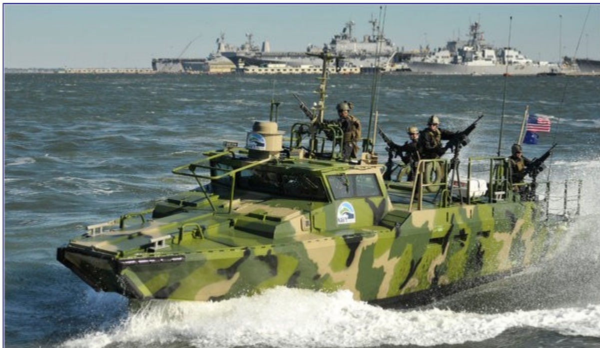
Le Riverine Command Boat , vedette de combat expérimentale alimentée par un mélange de gazole et de biocarburant à base de micro-algues. [US Navy]
